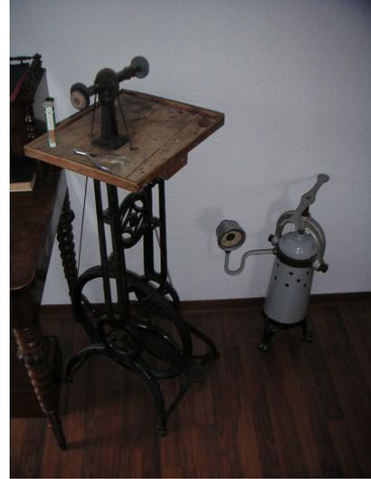
Poliermaschine mit Fußbetrieb und Kautschukprothesenkessel
